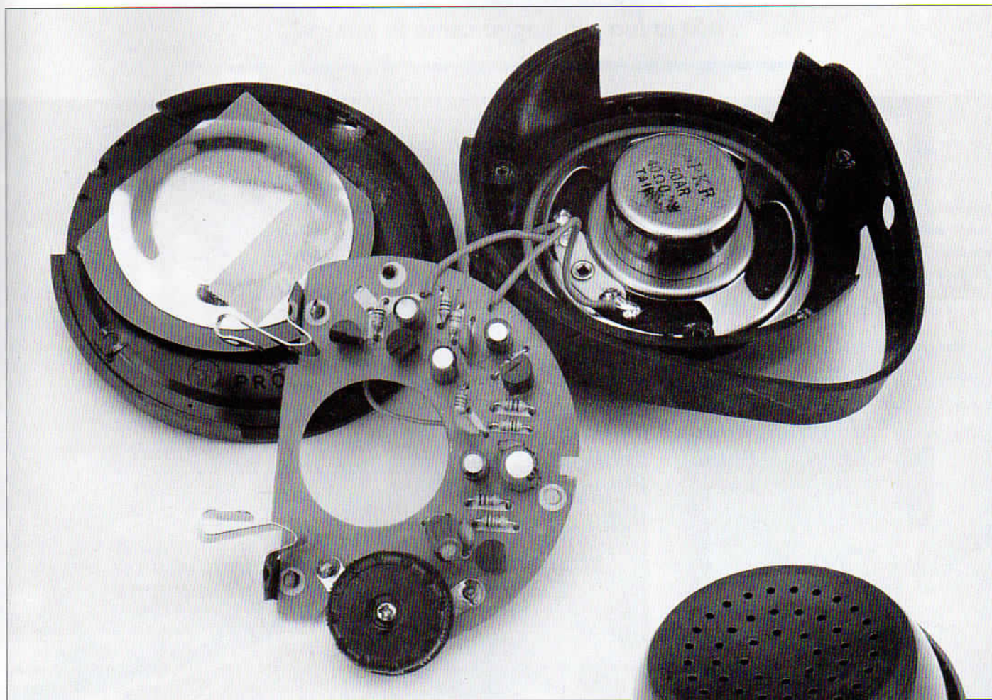
Il sensore è costituito da una bobina piatta formata da moltissime spire non isolate fra loro, connessa all'amplificatore e separata, mediante uno strato isolante, da una piastrina conduttrice.
